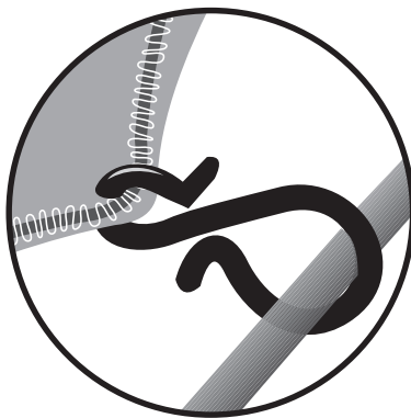
Fig. 3 Conexión de un conector "S" al cordón incluido en la malla.
